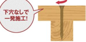
従来のウッドデッキ施工では下穴を開けるのが常識でしたが、デッキワン+は当社の開発経験から技術を盛り込み、「下穴不要、一発施工」を実現した製品です。デッキ施工の効率を大幅に向上させます。
