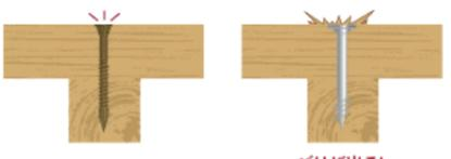
デッキワン+はこれまで堅い材では難しいとされてきた施工時のバリの発生を抑えることができます。施工後に行っていたバリ取り作業を軽減させます。
